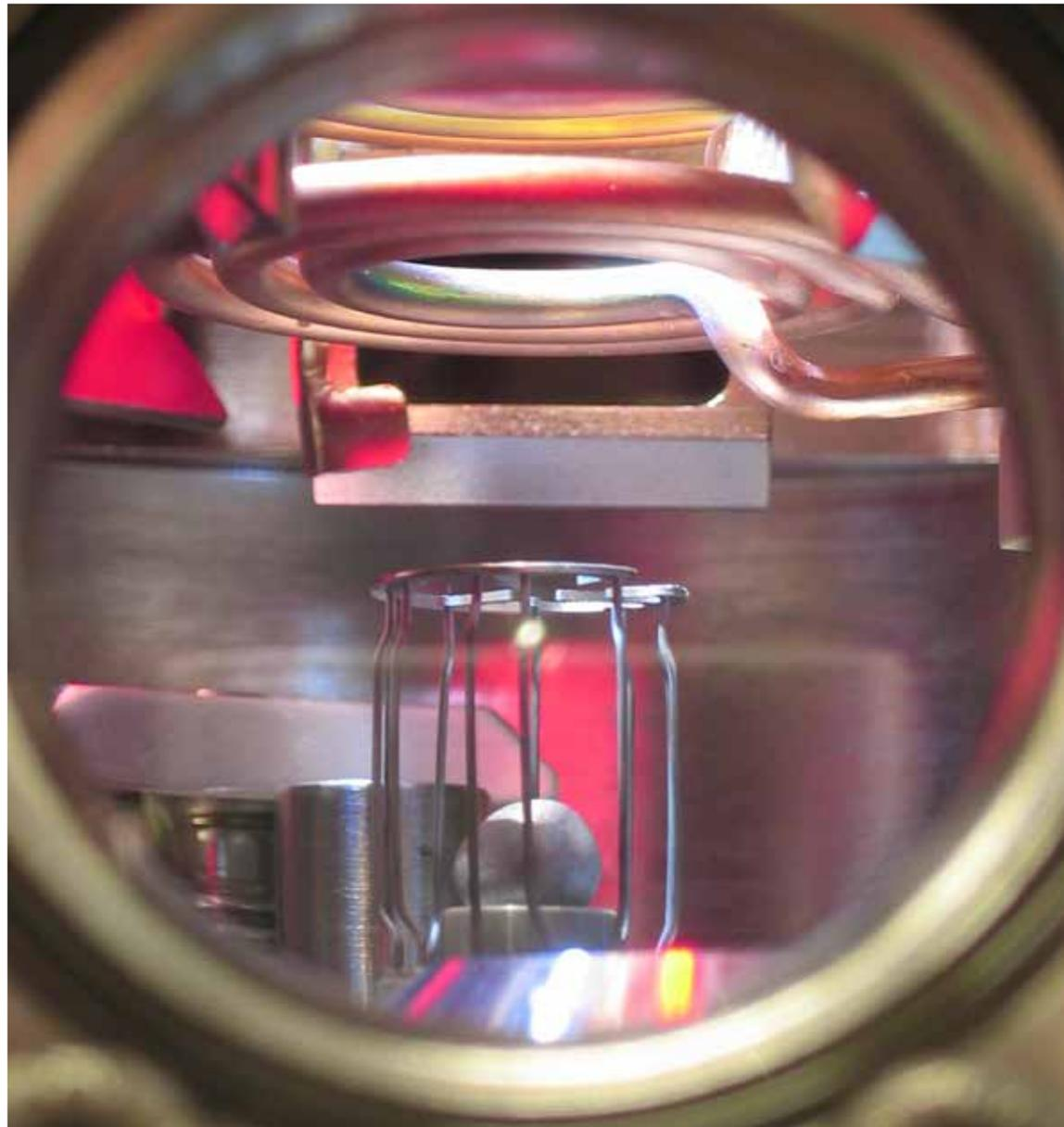
*Geschmolzene Experimentalproben nehmen in der Schwerelosigkeit unter einem elektromagnetischen Feld eine ideale kugelförmige Gestalt an. Dies erhöht beträchtlich die Genauigkeit der Messungen.*
