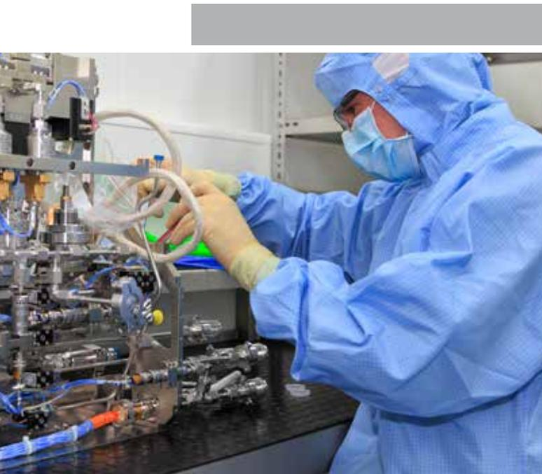
*Reinraum-Montagearbeiten an der Ultrahochvakuumkammer des Materialforschungsmoduls EML.*
