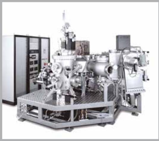
Cluster-Tool-Beschichtungsanlage zur Herstellung von Röntgenspiegeln.
