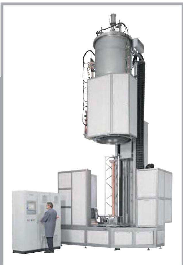
Вакуумная паяльная печь для FEL (Швейцария) высотой 6 м выполнена, в основном, из нержавеющей стали. Цилиндрическая камера печи может быть поднята и, с открытым колпаком, составляет высоту почти 9 метров. Эта специальная конструкция позволяет производить вакуумную пайку вертикально вставленной заготовки диаметром до 800 мм и высотой до 2700 мм, с весом садки до 1000 кг.
