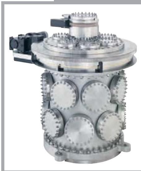
*Система измерения вакуума для фундаментальных исследований (скорость натекания  $\leq 10^{-9}$  мбар $\cdot$ л/с), кроме всего прочего, имеет 2-кратное дифференциальное вакуумирование вращающихся соединений DN 160 CF и DN 500 COF и систему измерения положения (угловая точность 0,001 $^\circ$ ), приводимая в действие шаговым двигателем (скорость вращения  $\sim 0,5$  об/мин).*
