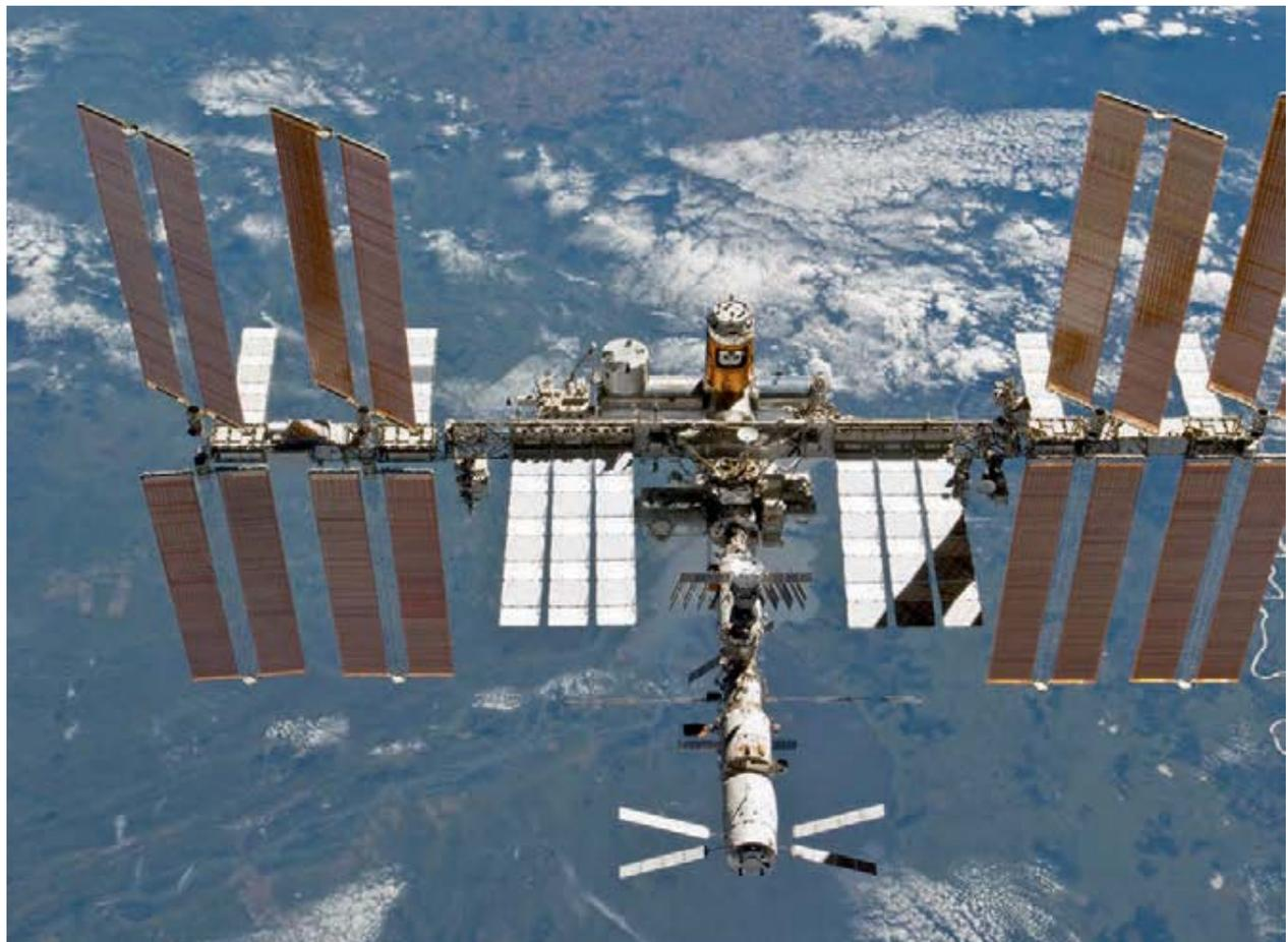
Вид из космоса на Международную космическую станцию на фоне Земли. Рядом с центральным модулем (покрыт золотом) находится европейская космическая лаборатория Columbus. Компания PINK выпускает многочисленные системы для Columbus, некоторые из которых уже установлены, включая 400 метров различных магистралей и каналов диаметром от 1/4 "до 2". Пристыкованный модуль (на переднем плане внизу) - это ATV космический транспортный корабль, для которого PINK произвел различные компоненты.
