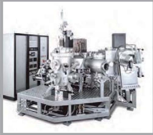
Кластерная система напыления для производства рентгеновских зеркал
