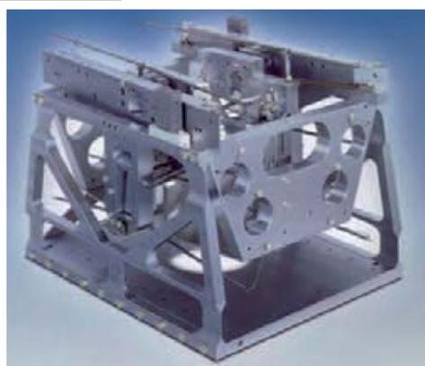
*В этой системе для избирательного отклонения синхротронного излучения PINK отвечает за регулировку зеркал с твердотельными элементами (то есть без движущихся частей).*
