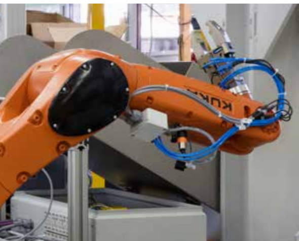
Aufbau einer vollautomatischen Helium-Dichtheitsprüfanlage mit Robotern zum Transfer der Prüflinge innerhalb der einzelnen Prozesstationen.
