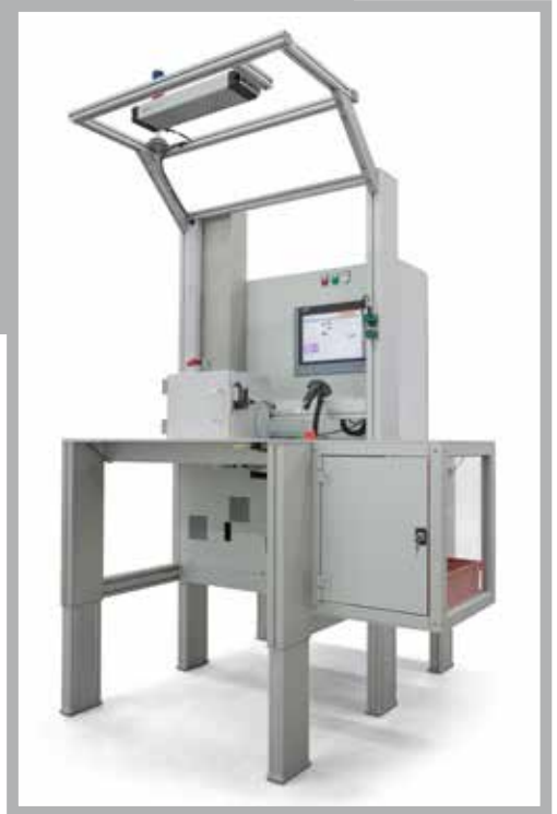
Ergonomisches Lecktestsystem für Kleinserien mit höhenverstellbarem Messplatz, Touch-Panel und homogener Arbeitsplatzausleuchtung.
