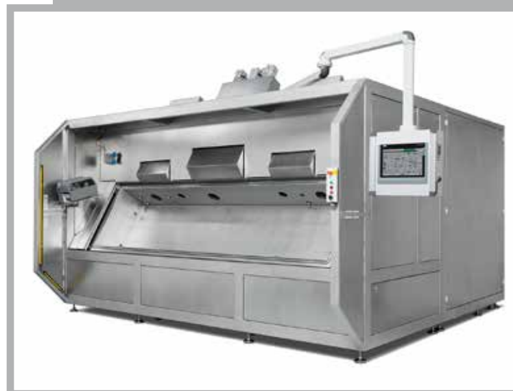
Kundenspezifisches System mit 1.400-Liter-Kammer, vollautomatischer Testgaskontrolle und Anlagenkalibrierung, Taktzeit: 35 Sekunden.
